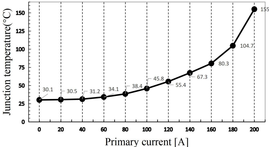
Note: >100A 应用请注意 PCB 板的电流线布局导线阻抗及散热能力
