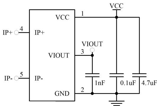
注：4.7uF 电源滤波电容必须使用以保证性能
